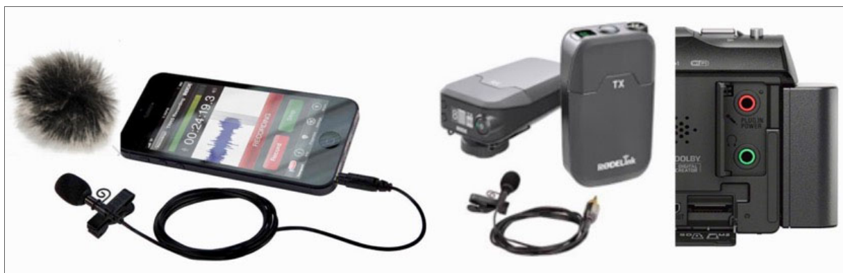
Fig. 4: Microfoni semplici con cavi per smartphone sono già disponibili a partire da 20 euro. Il collegamento radio RodeLink offre un buon rapporto qualità-prezzo. Quando si acquista una videocamera, assicurarsi che ci siano collegamenti per microfono (jack rosso) e cuffie (jack verde). Purtroppo, questi collegamenti sono disponibili solo per pochi modelli del segmento consumer.
